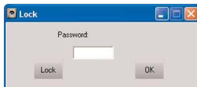
Esta función está accesible en el menú “Tools”. Puede bloquear el acceso a un recinto con una clave de acceso, 4 caracteres como máximo son necesarios, entre su clave de acceso y haga un clic en Lock, podrá modificar los parámetros accediendo a la parte “Unlock” (Tools/Unlock), entrando la clave de acceso y haciendo un clic en “Unlock”.
