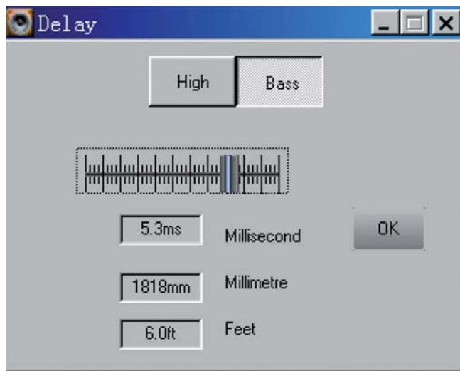
Ce paramètre ajoute un “delay“ au signal, la valeur est exprimée en temps ou en distance.
