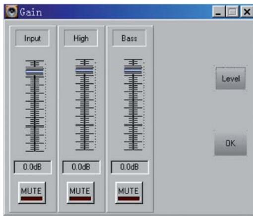
Puede modificar la ganancia de entrada, el potenciómetro de ganancia de las frecuencias de los agudos “High” y el potenciómetro de las frecuencias de los graves “Bass”. También puede cortar la parte deseada haciendo un clic en “MUTE”, zona de variación: -60 dB a +6 dB.
