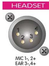
**NOTE:** Les casques peuvent être à un ou deux écouteurs. Dans le cas d'utilisation d'un casque à deux écouteurs, les deux speakers doivent être montés en mode parallèle.
