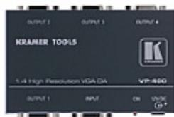
Le **VP-400** est un distributeur amplificateur hautes performances pour des signaux video graphique avec des résolutions allant de VGA jusqu'à UXGA et plus haut. Il possède une entrée, l'amplifie, l'isole parfaitement et la distribue sur quatre sorties identiques.
